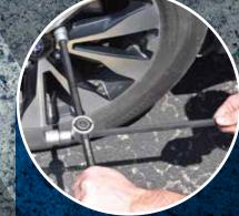
SLIDING ARMS GIVE EXTRA LEVERAGE FOR REMOVING LUG NUTS
