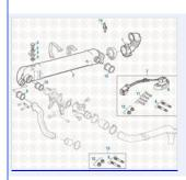
**Detroit Diesel Engine 2019** EGR Cooler - DD15
