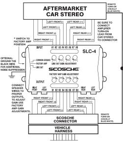
\* WITH SOME FORD PREMIUM SOUND OR DELCO BOSE COMMON GROUND SYSTEMS, IT MAY BE NECESSARY TO USE THE "COMMOND GROUND" OR "LINE OUT" SWITCH POSITION
