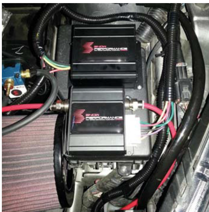
Einbaubeispiel: SafeInjection- und Stage 2 Controller im Motorraum (Mazda 3 MPS)
