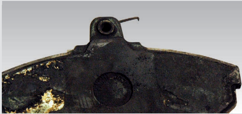
► Hold-down spring broken
