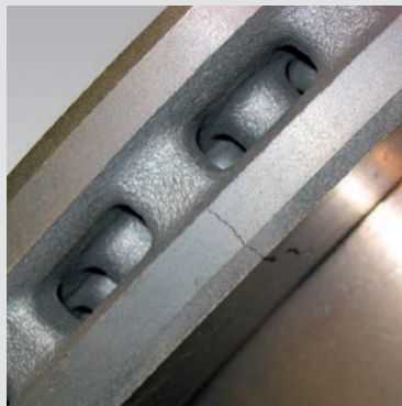
► Cracked brake disc
